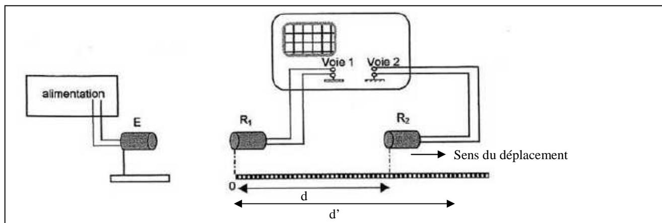
L'émetteur E produit une onde ultrasonore progressive sinusoïdale qui se propage dans l'air jusqu'aux récepteurs (microphones) R<sub>1</sub> et R<sub>2</sub>. L'émetteur et les deux récepteurs sont alignés.
